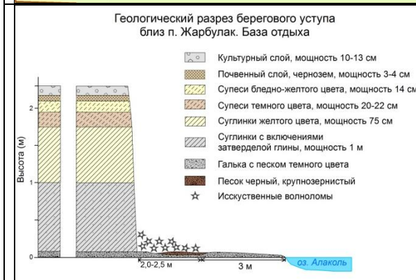
Рисунок Б.31 – Схема мониторинговой площадки № 1, зона отдыха с. Кабанбай, ВКО
