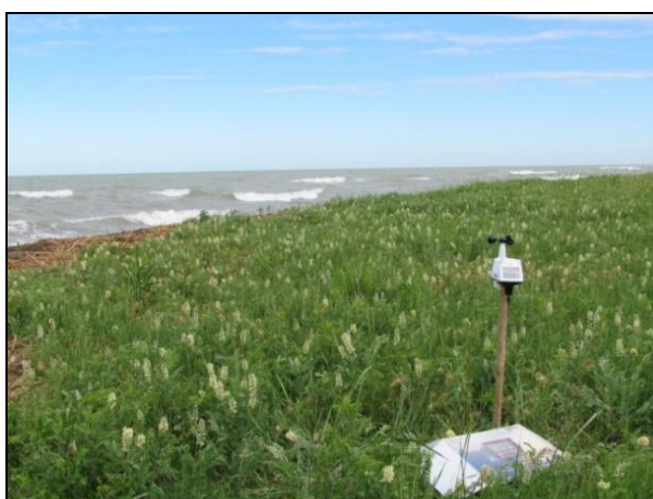
Рисунок А.47 – Метеостанция Davis Vantage Vue
