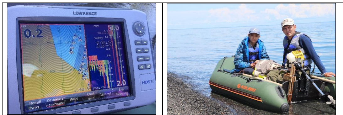
Рисунок А.4 – Батиметрическая съемка эхолотом LOWRANCE, береговая зона озера Алаколь у с. Коктума
